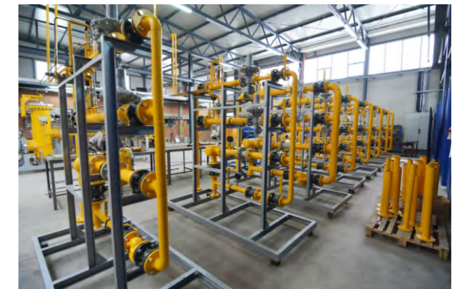
Mjesto ugradnje: Bačka Palanka za firmu Novi Sad-Gas d.o.o. (Srbija) REGULACIONE STANICE Q = 2.500 \text{ m}^3/\text{h} \mid p = 12 \text{ bar}
