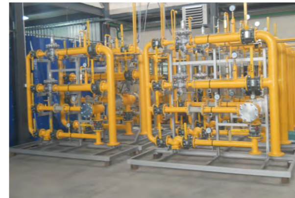
Mjesto ugradnje: Bačka Palanka za firmu Novi Sad-Gas d.o.o. (Srbija) REGULACIONE STANICE Q = 2.500 \text{ m}^3/\text{h} \mid p = 12 \text{ bar}
