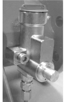
Abb. 9 | Druckknopfölpumpe
